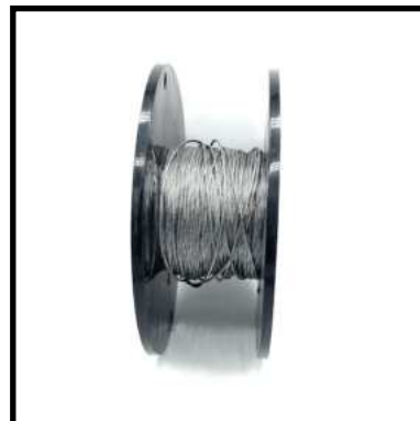
Stahldrahtseil 1,5 mm \varnothing , verzinkt Konstruktion: 7x7 Seilfestigkeitsklasse: 1960 N/mm 2 DIN EN 3055 Art-Nr. 01-601150-01 Verpackungseinheit: 100 m Rolle 39,90 € per Rolle
