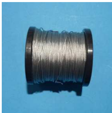
Stahldrahtseil 1,0 mm \varnothing , verzinkt Konstruktion: 6x7 - WSC (7x7) Seilfestigkeitsklasse: 1770 N/mm 2 DIN EN 12385-4 Art-Nr. 01-600101-01 Verpackungseinheit: 100 m Rolle 35,00 € per Rolle
