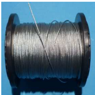
Stahldrahtseil 1,25 mm \varnothing , verzinkt Konstruktion: 6x7 - WSC (7x7) Seilfestigkeitsklasse: 1770 N/mm 2 DIN EN 12385-4 Art-Nr. 01-601125-01 Verpackungseinheit: 100 m Rolle 35,70 € per Rolle
