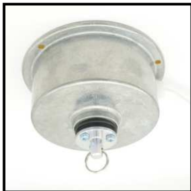
Hängedrehbühne 5 kg Tragkraft zur Deckenbefestigung, Achse mit Einhängeloch und Ring, verzinktes Gehäuse, Gehäusedurchmesser: 130 mm Gesamthöhe: 85 mm Drehzahl: 2,5 U/Min. (linksdrehend) Betriebsspannung: 220 - 240 V Art-Nr. 05-100101-08 110,50 € per Stück Art-Nr. 05-100102-08 mit Schleifkontakt für Stromübertragung max. 4 Ampere (bis 900 Watt) 166,20 € per Stück
