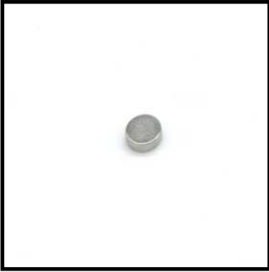
Neodym-Scheibenmagnet 6 mm \varnothing x 2 mm vernickelt, axial magnetisiert, NdFeB, N35, Haftkraft: ca. 0,5 kg Art-Nr. 03-050006-03 Preis: auf Anfrage
