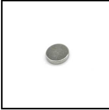
Neodym-Scheibenmagnet 10 mm \varnothing x 2 mm vernickelt, axial magnetisiert, NdFeB, N35, Haftkraft: ca. 1 kg Art-Nr. 03-050010-03 Preis: auf Anfrage
