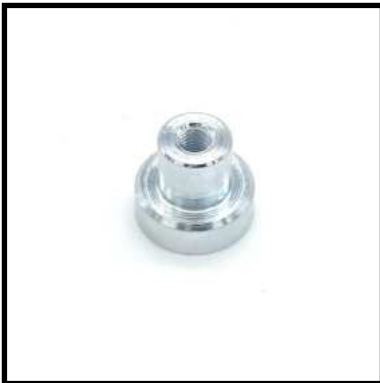
Flachgreifer aus Neodym-Eisen-Bor, verzinkt mit Gewindebuchse M3 20 mm \varnothing , 4,5 mm hoch, Haftkraft: 2,5 kg Art-Nr. 03-610010-01
